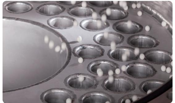
Ein Activepowerclean Wärmetauscher bleibt dank zirkulierender Keramikugeln zuverlässig sauber.
