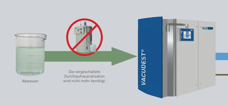
Der Destcontrol lässt sich überall dort einsetzen, wo konstante Destillatqualitäten für die Kreislaufführung gefordert werden. Besonders geeignet ist er für alkalische oder leicht saure Wässer. Er ersetzt konventionelle Durchlaufneutralisationen zum Beispiel bei der Abwasseraufbereitung in der Lackiervorbehandlung oder im Aluminiumdruckguss.
