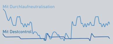
Vergleich von pH-Wert-Schwankungen im Destillat: Destcontrol erreicht zuverlässige, stabile Werte.
